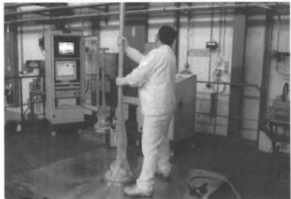
図1 UP1におけるスラッジの汲み取り作業
